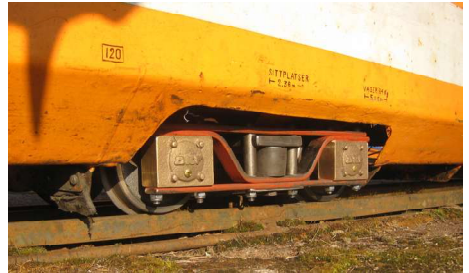
Färdig omålade boggi provmonterad på en vagnkorg innan ommålningen. Här kan man se gummikutsen för fjädringen.
