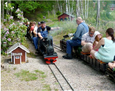
Artighet är en dygd oss lokförare emellan. Här överlämnas mässingsstaven ("token" eller "train staff", på det engelska språket) till det väntande loket på Rustansberg.
