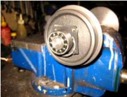
Axel med monterade hjul. Tvåradiga sfäriska kullager monterade på axeln och låsta med låsring på utsidan. Låsringen för kullagret i axelboxen syns framför rågummitätningen.
