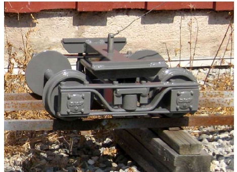
Boggin till höger kan monteras som en jacobsboggi mellan de båda vagnarna om man vill ta bort drivenheten. Man får då två vagnar som tillsammans kan användas i ett vanligt tågset.
