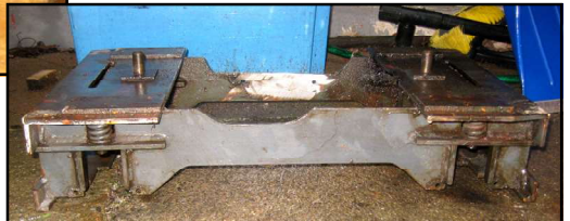
Gamla motorboggien innan renovering.
