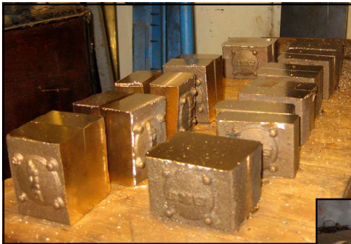
Nya lagerboxar är gjutna och är nu under bearbetning.
