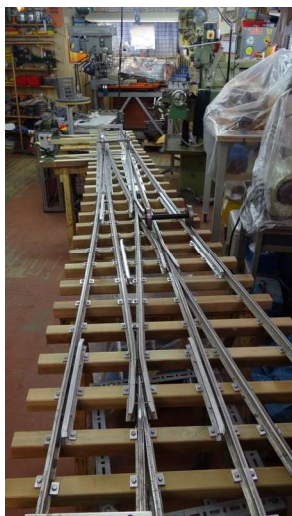
Gunnar Lindberg bygger på sitt diesel-hydrauliska lok MY, till höger, men får sticka emellan med bygget av en trevägsväxel här nedan för framtida utbyggnad av Rustansbergs station.
