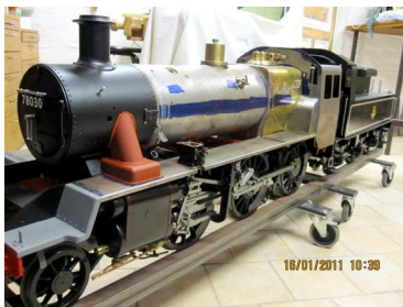
Jannes lok, ett långvarigt bygge. Notera den fina ångbroms- ventilen, ett komplicerat bygge.
