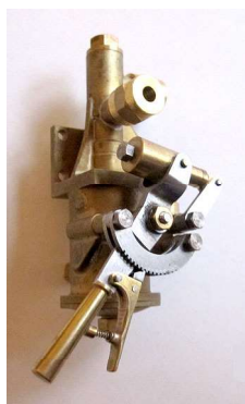
Jannes lok, ett långvarigt bygge. Notera den fina ångbroms- ventilen, ett komplicerat bygge.
