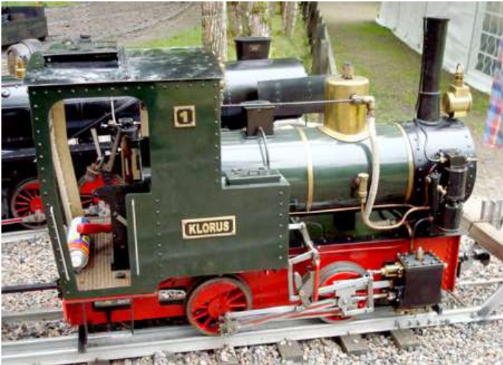
Modell av ett lok från Orenstein & Koppel med original 750 mm spårvidd. Loket i 7¼" skala är byggt av Tom Phielix från Holland. Ett mycket vackert lok med en del finesser och som är underbart att köra. Foto: Björn Bergman
