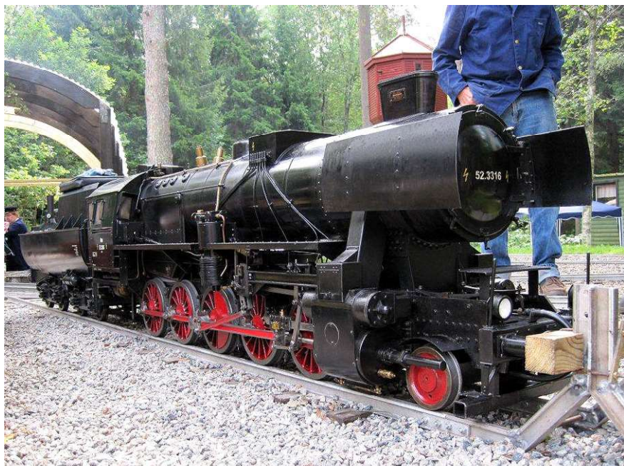
Detta fina "Kriegslok", typ 52, har byggts av Richard Gomersall från England och besökte vår bana för första gången. Ett mycket fint bygge som imponerade mycket på alla. Hjulställningen 2–10–0 borgar för en enastående dragkraft. Foto: George van Rooijen.
