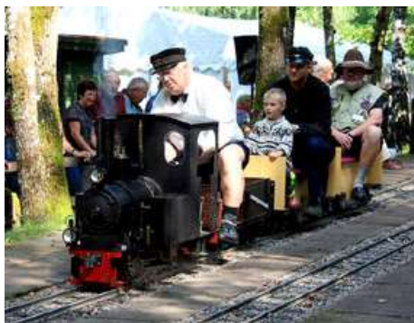
Här nedan ser vi Måns med glada resenärer bakom sitt smalspåriga torvbanelok. Loket har hjulställningen 0-6-0. Originallets spårvidd var 600 mm.
