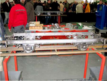
Normalspårig vagn under byggnad. Notera att koppelfjädringen inte är med genomgående dragstång utan sitter i båda buffertbalkarna.
