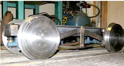
Bild 3. Massiva hjul av axelstål med sin upphängning i en lagerbalans.
