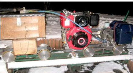
Bild 5. Första provkörningen med båda boggierna tätt sammankopplade.
