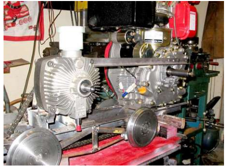
Bild 2. Motor och hydrostat.
