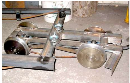
Bild 4. Boggi monterad på chassit med rollbordskullor till bolsterlagringen.
