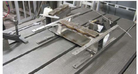
Centrala delarna av boggin monterade innan slutliga nitningen påbörjas.
