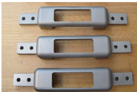
Tre av lokets åtta bindjärn färdigbearbetade.
