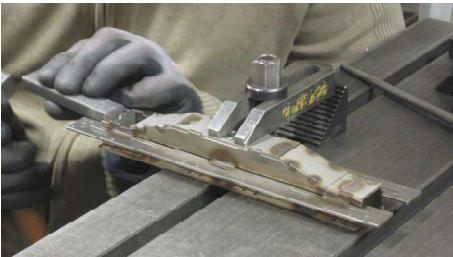
Centrala delen av boggin, den s.k. vaggbalken och omgivande l-balkar svetsas samman som en enhet. Det är också viktigt att svetsa fogarna i rätt ordning för att få den färdiga delen rak .
