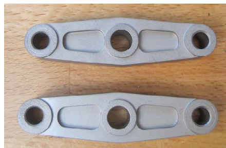
Två bearbetade balansarmar till lokets fjädringssystem.
