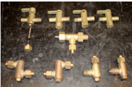
Pyskranar och flera backventiler.
